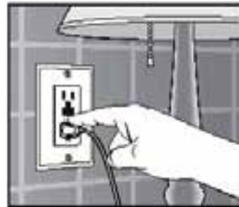
Oprima el botón TEST en el GFCI. Si funciona adecuadamente, el GFCI se disparará y la alimentación a la lámpara o al radio se cortará.
