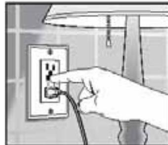
Si la energía no se cortó cuando presionó el botón TEST, entonces hay un problema eléctrico y la protección puede estar vulnerable. Comuníquese con un electricista capacitado.
